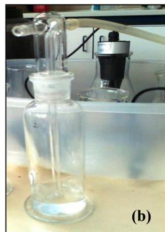
Figura 4.1 - (a) Reator laboratorial de compostagem, (b) Sistema de recolha de gases.
