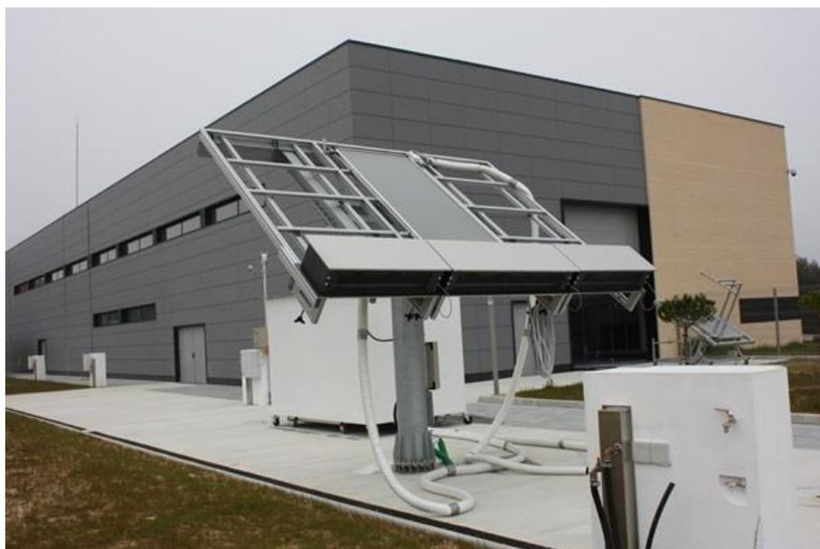
**Figura 6.3** Coletor solar durante um ensaio de exposição no LSE.
