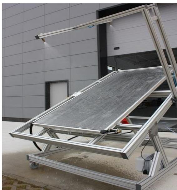
**Figura 6.6** Ensaio de penetração de chuva segundo a EN 12975:2006.
