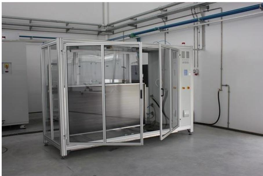
**Figura 6.2** Equipamento de ensaio de pressão interna do LSE.
