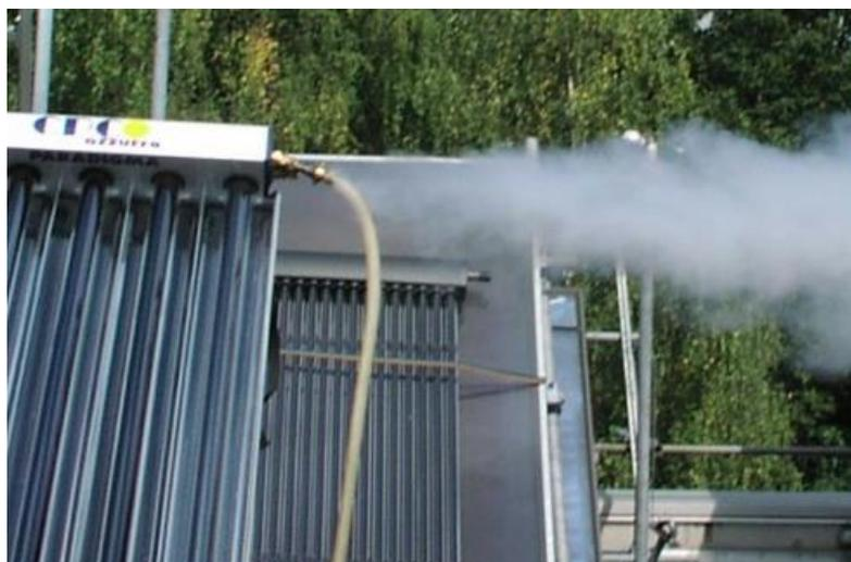
**Figura 6.5** Ensaio de choque térmico interno. Adaptado de “Drück (2009)”
