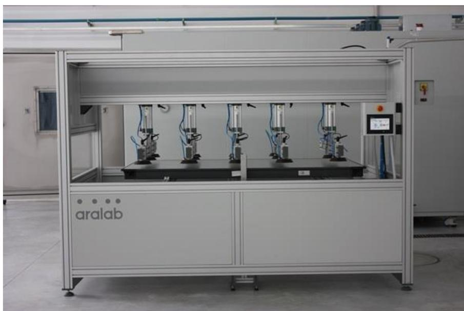
**Figura 6.7** Equipamento de carga mecânica positiva e negativa do LSE.
