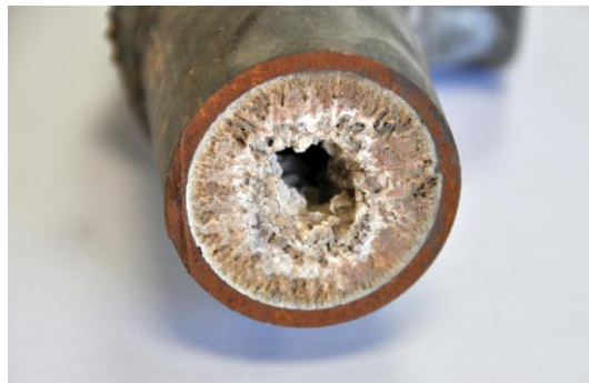
Figura 3.7 – Tubagem com incrustação de calcário (Reprodução de (Urgences & Dépannages, 2013)),
