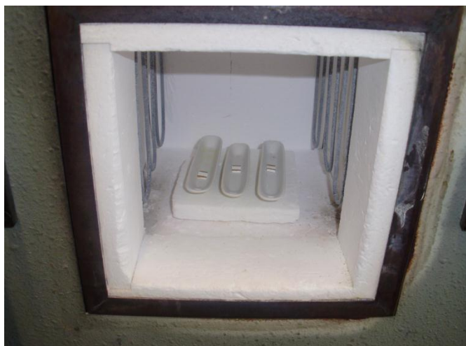
Figura 21: Amostras com extremidades pintadas com a tinta de ouro e colocadas no interior do forno.
