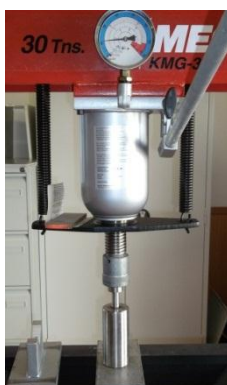
Figura 19: Prensa pneumática exercendo pressão no molde
