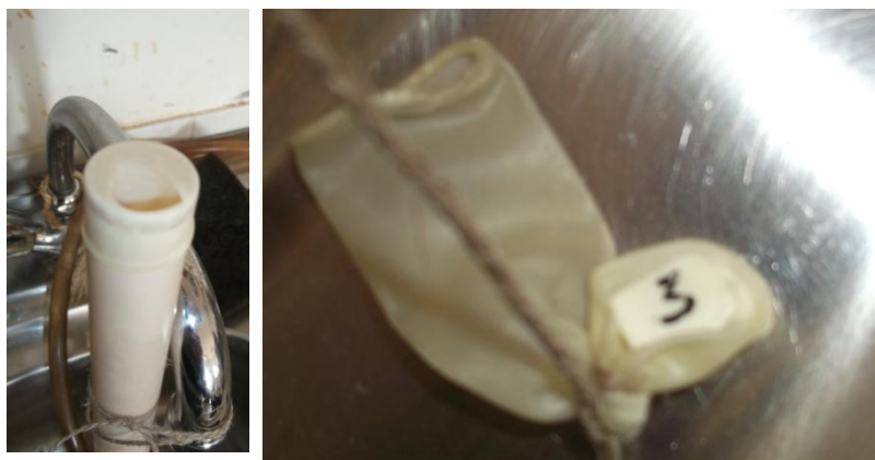
Figura 17: Amostra colocada em vácuo. Do lado esquerdo, colocação da amostra na dedeira. Do lado direito, a amostra em vácuo.
