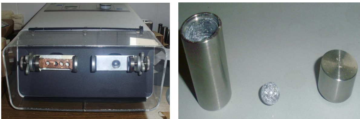
Figura 13: Máquina para homogeneizar a mistura à esquerda, e à direita o recipiente onde é colocado o pó.
