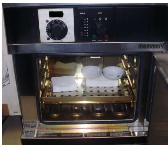
Figura 14 : Mufla para extrair a humidade existente nos pós.
