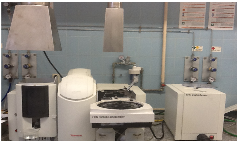
Figura 5.3- Aparelho de espectrofotometria por absorção atômica com câmara de grafite
