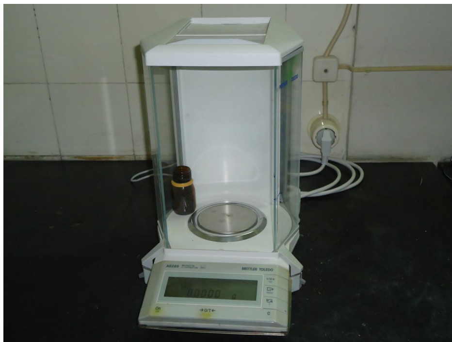
Fig. 8 – Balança de precisão (Mettler Toledo) usada para determinar as massas das amostras.
