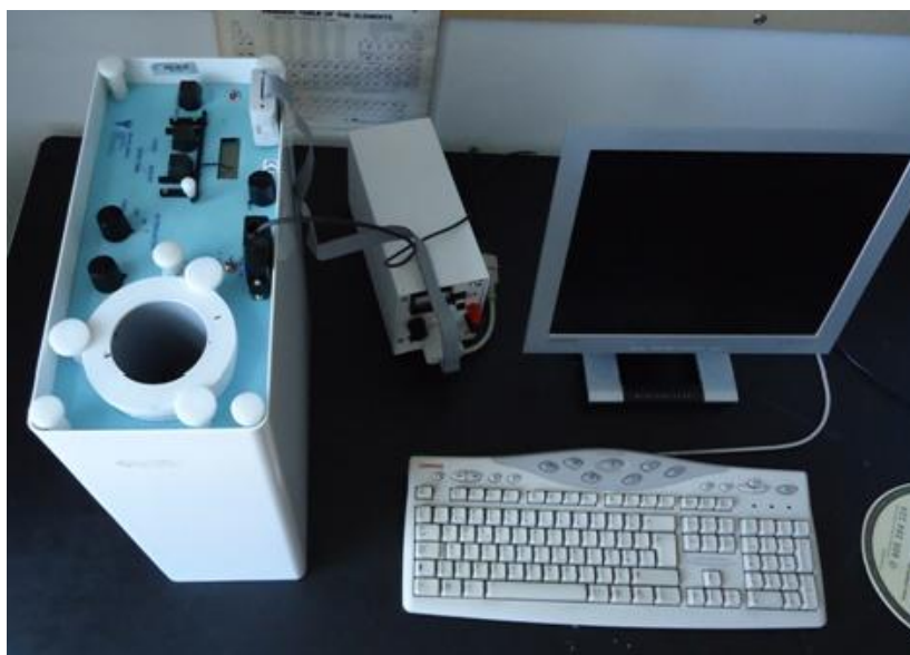
Fig. 7 – Magnetômetro rotativo (Molspin) usado na medição da Magnetização Remanescente Isotérmica (MRI).
