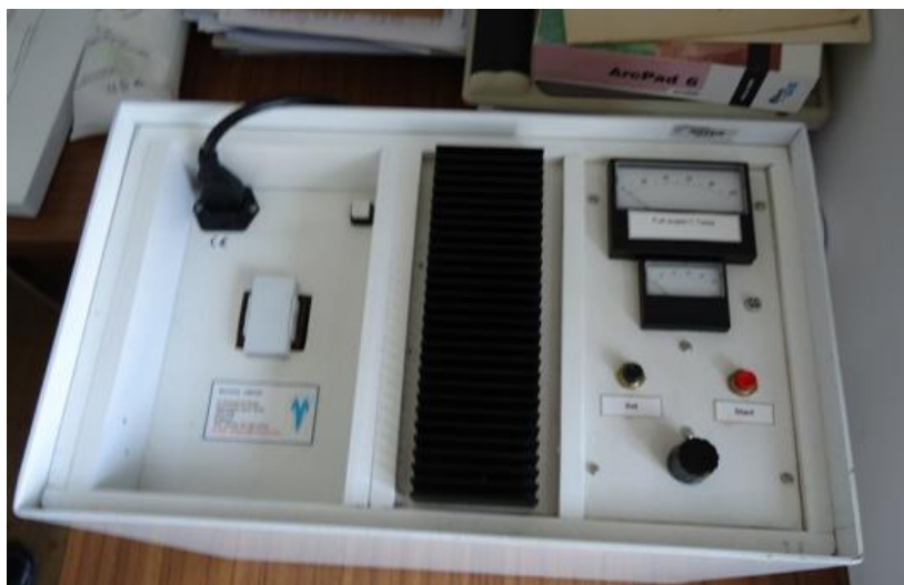
Fig. 6 – Magnetizador (Molspin) usado para magnetizar as amostras.
