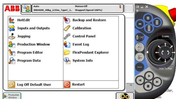
Figura 4.1. Visão geral do controlador virtual
