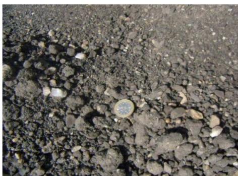
*Figura 2.5 - Agregado Reciclado, agregado obtido após fresagem de camada de mistura betuminosa (Antunes, 2016)*
