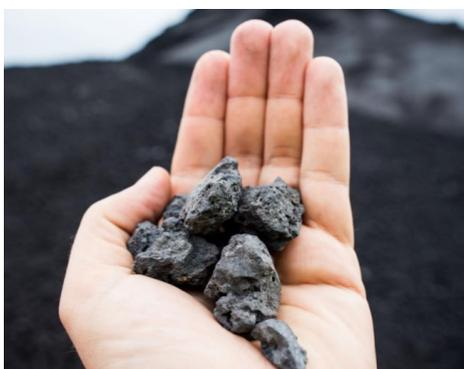
*Figura 2.4- Agregado Artificial, ASIC- Agregado Siderúrgico Inerte para a Construção (Oliveira, 2016)*
