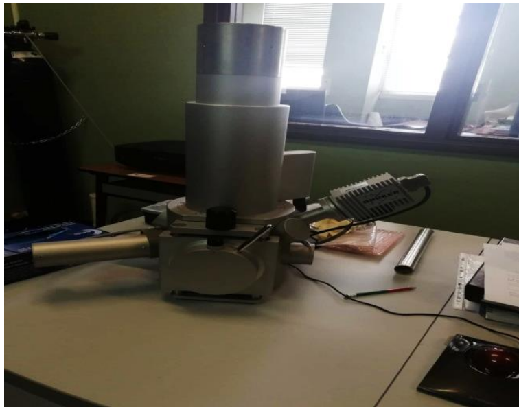
Figure 4: MEB TESCAN VEGA3 Le microscope utilisé étai un TESCAN VEGA3 SBH opéré à 20 kV.
