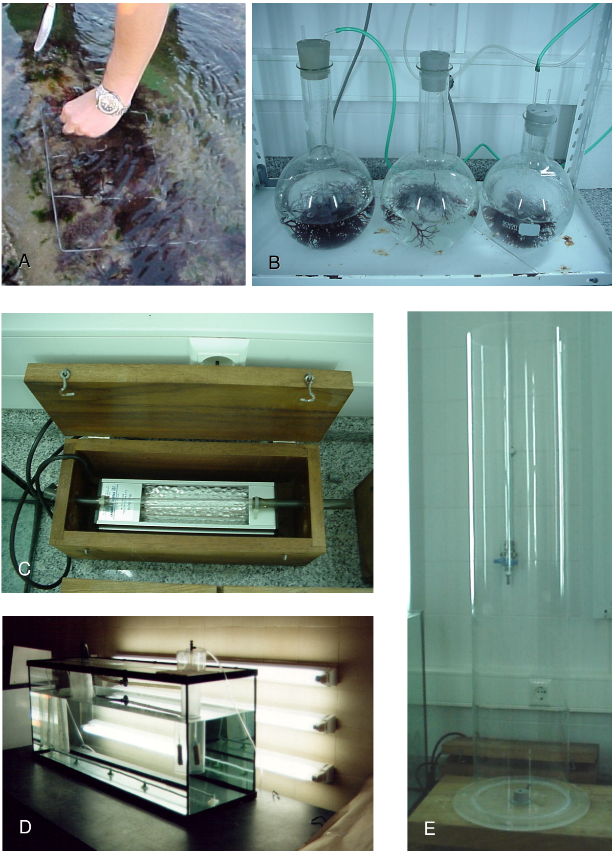
Figura 2.4 – Colheita e cultura laboratorial de carragenófitas: colheita das algas inteiras com auxílio de uma faca (A); cultura em balões de vidro (B); equipamento de esterilização por UV (C); cultura de manutenção em aquário (D); cilindro de “plexiglass” para produção de biomassa (E).
