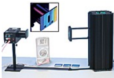
Figura 3.1.3.1 – Dispositivo experimental, da Pasco, para medir a razão h/e ( http://store.pasco.com/pascostore/showdetl.cfm?&DID=9&Product_ID=1548&Detail=1 ).
