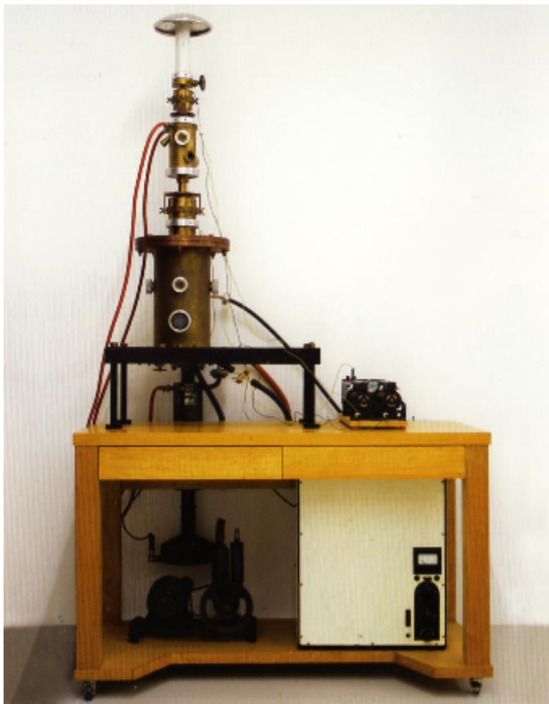
Figura 4.5.1 – Um dos primeiros microscópios electrónicos de transmissão desenvolvidos por E. Ruska (Melo, 2005, p. 61).
