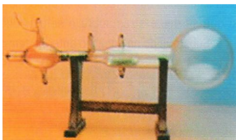
Figura 2.3.2.5 –Tubo de raios catódicos original utilizado por J. J. Thomson, para medição da razão entre a carga e a massa dos electrões, e/m (Ventura, 2005, p. 269).
