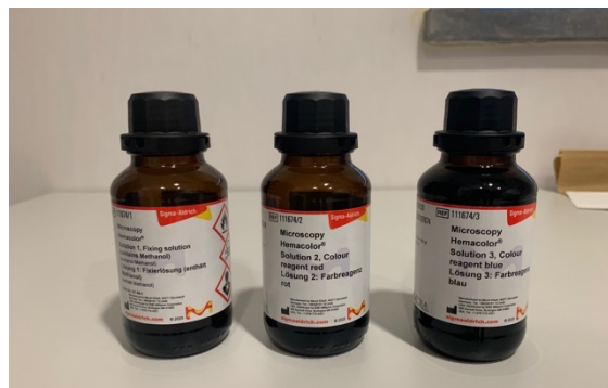
Figura 11 - Kit de Coloração: Solução 1 - Solução de fixação; Solução 2 - Solução de Eosina; Solução 3 - Solução de azul de metileno
