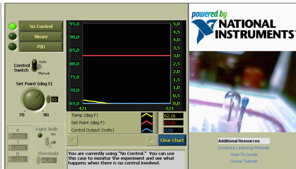
**Figura 3 – Ambiente de trabalho da experiência “Demonstração de controlo da temperatura” (Temperature Control Demo)**
