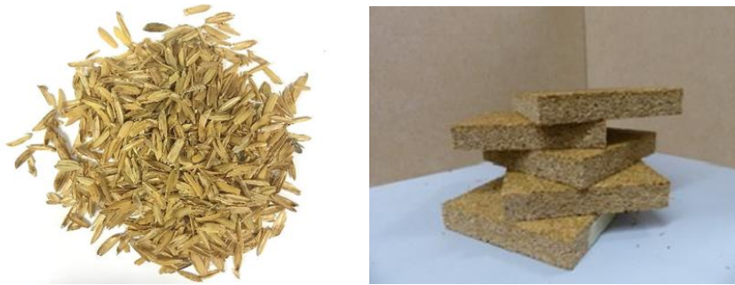
Figura 3.2 Casca de arroz e painel de casca de arroz produzido em laboratório. Fonte: Marques et al. (2020)
