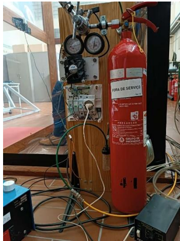
Figura 3.8. Sistema de injeção de CO 2 .
