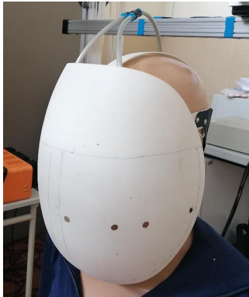
Figura 3.9. EPI perfurado nos pontos PV1, PV2, PV3, PV4.
