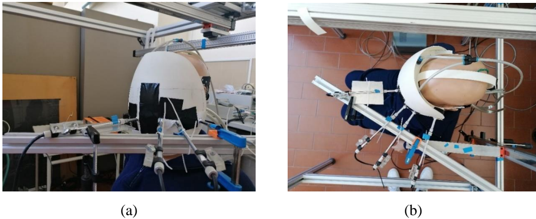
Figura 3.10. Montagem das sondas de velocidade nos primeiros pontos: (a) vista lateral/frente; (b) vista de cima.
