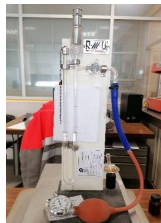
Figura 11. Equipamento para teste de Blaine (permeabilímetro).
