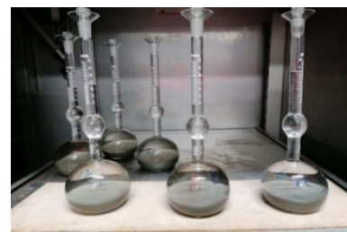
Figura 10. Densímetros de Le Châtelier na câmara climática para determinação da massa volúmica.
