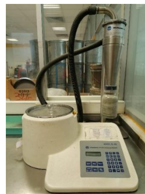
Figura 12. Granulómetro Alpine LS 200N utilizado para a determinação do resíduo de peneiração.
