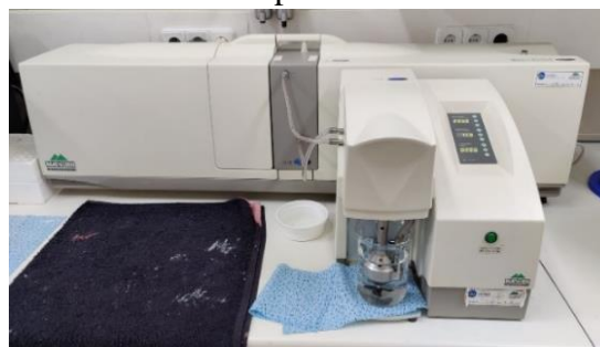
Figura 13. Mastersizer 2000 da Malvern Panalytical com acoplamento do sistema Hydro 2000MU .
