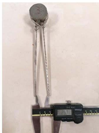
Figura 16. Medição do afastamento relativo das agulhas de Le Châtelier , após submetidas a um banho de água.
