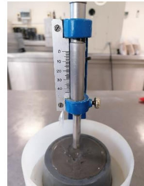
Figura 14. Sonda normalizada para medição da consistência das pastas.
