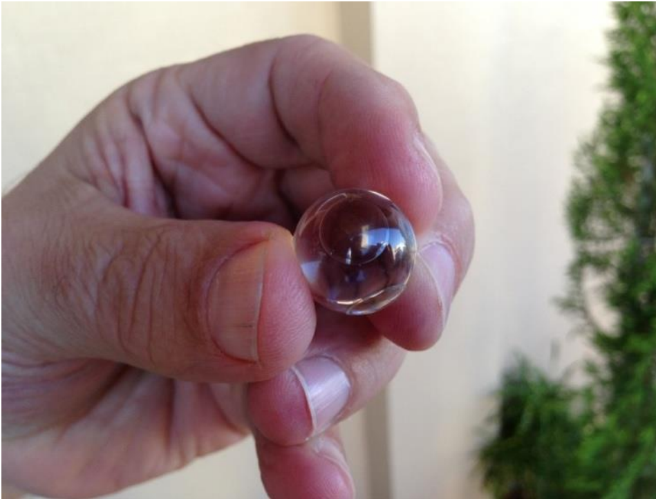
Figura 9: Esfera de PMMA sobre a qual foi colocada uma lente de contato com o objetivo de aproximar o foco do sistema da superfície da esfera.
