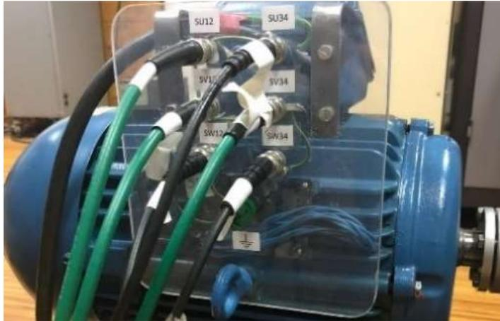
Figura 29 – Terminais para a aquisição das tensões induzidas.
