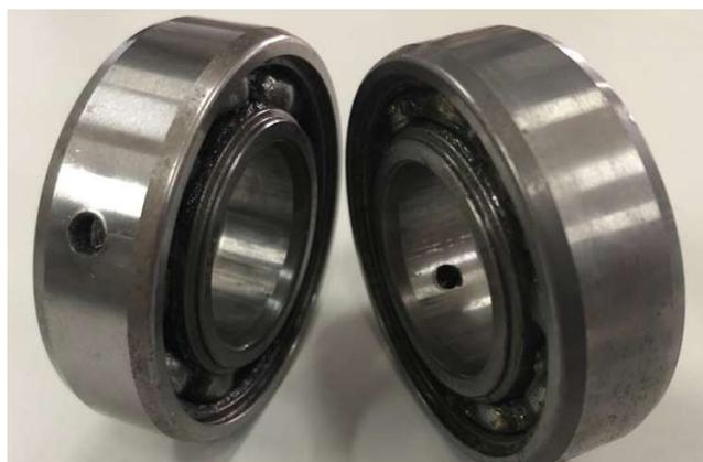
Figura 27 – Rolamentos com falhas, do lado esquerdo: furo de 4mm no anel externo do lado do ventilador e do lado direito: furo de 4mm no anel interno do lado do ventilador.
