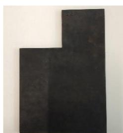
**Figura 4.1:** Ilustração do ânodo DSA utilizado no processo de eletro-oxidação.
