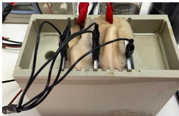
**Figura 5.7:** Espuma formada ao fim de 15 min de eletro-oxidação do lixiviado AL2 ( $NE=5$  e  $J=15 \text{ mA/cm}^2$ ).
