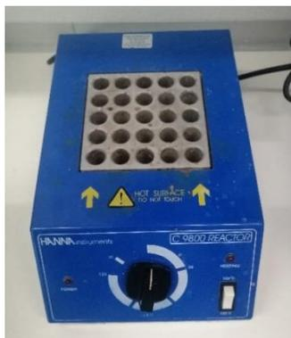
**Figura 4.4** - Digestor de amostras.
