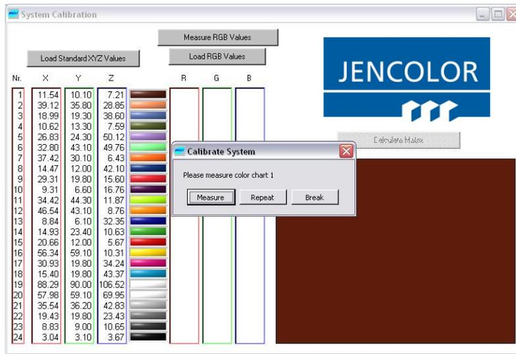
Figure 30; System Calibration: Entering the actual values
