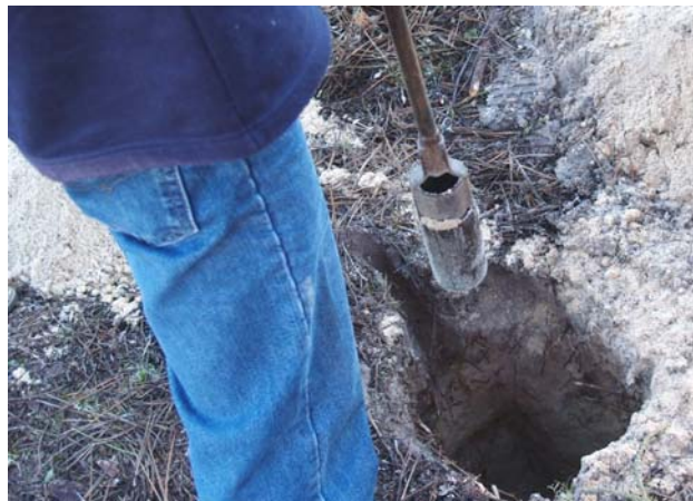
Figura 1.2 - Detalhe do amostrador 1 e do aspecto da escavação inicial.
