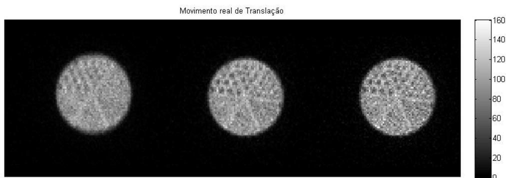
Fig. 6.34b – Imagens obtidas para o ensaio realizado com actividade igual a 0,3 mCi e movimento de translação. Esq<sup>a</sup>.: imagem sem correcção de movimento; Meio: imagem da 1<sup>a</sup> iteração; Drt<sup>a</sup>: imagem da 20<sup>a</sup> iteração. Matriz de “baixa densidade”.
