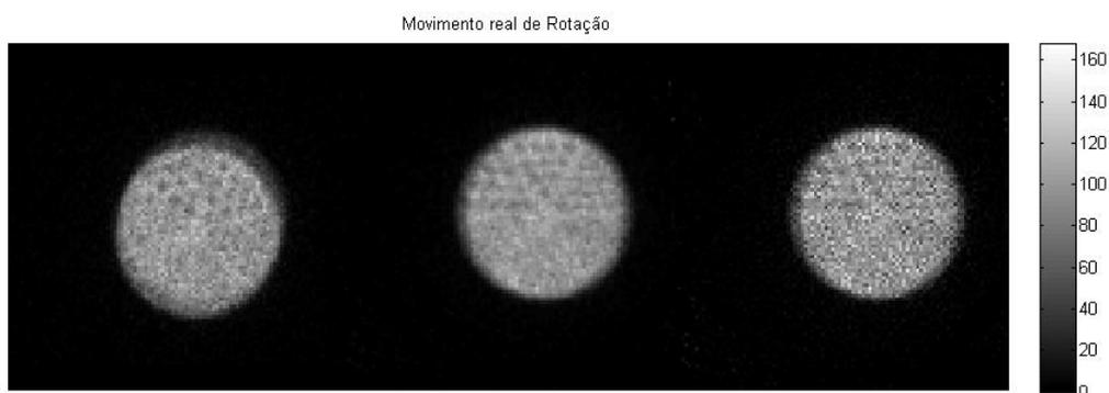
Fig. 6.32a – Imagens obtidas para o ensaio realizado com actividade igual a 0,3 mCi e movimento de rotação. Esq<sup>a</sup>.: imagem sem correcção de movimento; Meio: imagem da 1<sup>a</sup> iteração; Drt<sup>a</sup>: imagem da 20<sup>a</sup> iteração. Matriz de “alta densidade”.
