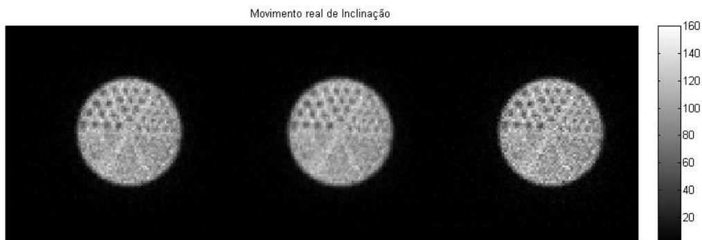
Fig. 6.30a – Imagens obtidas para o ensaio realizado com actividade igual a 0,3 mCi e movimento de inclinação. Esquerda: imagem sem correção de movimento; Meio: imagem da 1ª iteração do algoritmo de correção de movimento; Direita: imagem da 20ª iteração. Matriz de “alta densidade”.
