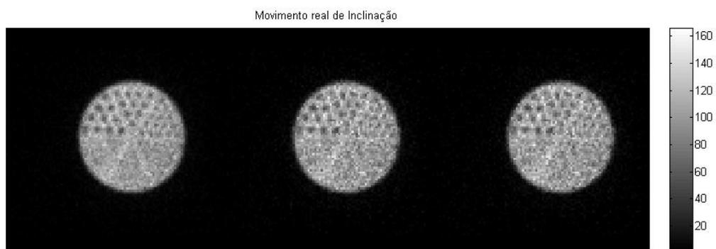
Fig. 6.30b – Imagens obtidas para o ensaio realizado com actividade igual a 0,3 mCi e movimento de inclinação. Esquerda: imagem sem correcção de movimento; Meio: imagem da 1<sup>a</sup> iteração do algoritmo de correcção de movimento; Direita: imagem da 20<sup>a</sup> iteração. Matriz de “baixa densidade”.
