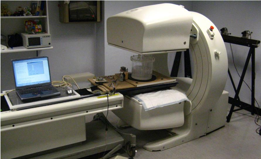
Fig. 5.18 – Disposição dos equipamentos durante a aquisição. Do lado direito podem ver-se as duas câmaras no respectivo suporte. Ao centro, o fantoma de Jaszczak encontra-se em cima da plataforma de movimentos que é controlada pelo computador mais à esquerda.
