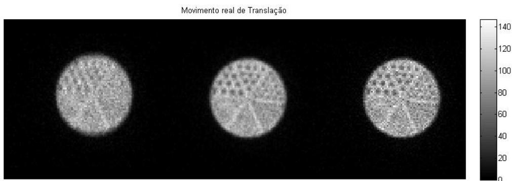
Fig. 6.34a – Imagens obtidas para o ensaio realizado com actividade igual a 0,3 mCi e movimento de translação. Esq<sup>a</sup>.: imagem sem correcção de movimento; Meio: imagem da 1<sup>a</sup> iteração; Drt<sup>a</sup>: imagem da 20<sup>a</sup> iteração. Matriz de “alta densidade”.
