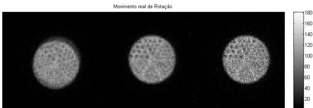
Fig. 6.32b – Imagens obtidas para o ensaio realizado com actividade igual a 0,3 mCi e movimento de rotação. Esq<sup>a</sup>.: imagem sem correcção de movimento; Meio: imagem da 1<sup>a</sup> iteração; Drt<sup>a</sup>: imagem da 20<sup>a</sup> iteração. Matriz de “baixa densidade”.
