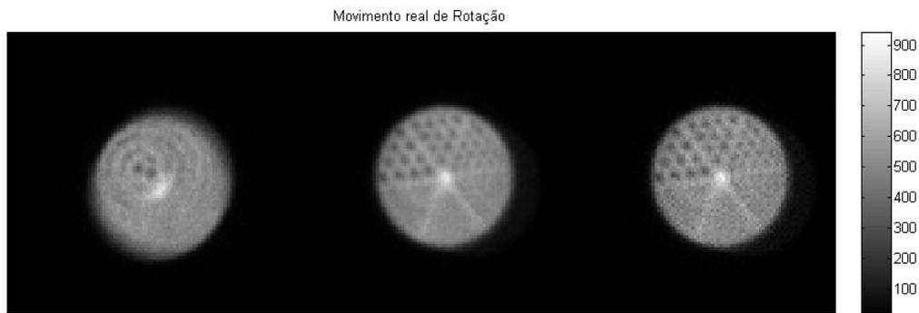
Fig. 6.39 – Imagens obtidas para o ensaio realizado com actividade igual a 3,5 mCi e movimento de rotação para 120 s de aquisição. Esq<sup>a</sup>.: imagem sem correcção de movimento; Meio: imagem da 1<sup>a</sup> iteração; Drt<sup>a</sup>: imagem da 20<sup>a</sup> iteração. Matriz de “alta densidade”.
