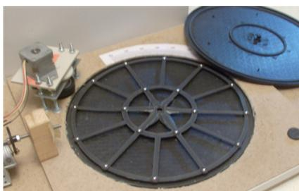
Fig. 5.30 – Pormenor da placa giratória de suporte utilizada na plataforma de movimentos. As esferas de ferro são perfeitamente visíveis.
