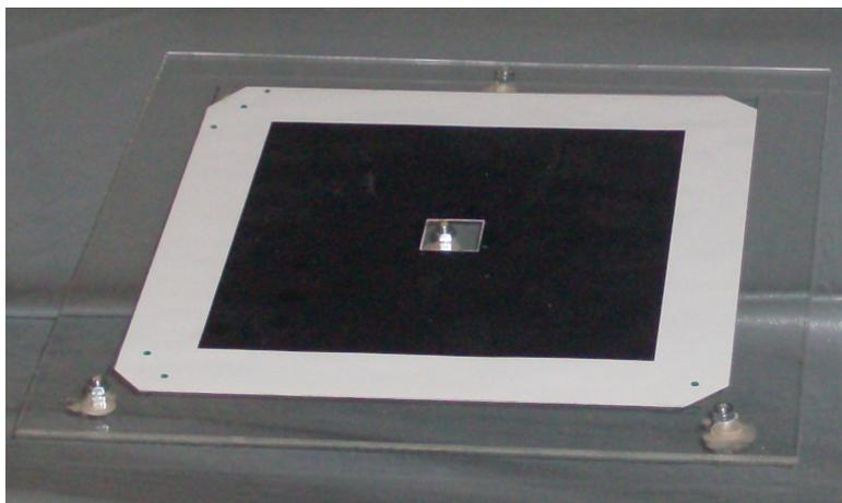
Fig. 5.20 – Alvo de calibração do sistema. Os vértices do quadrado preto constituem as marcas fiduciais que se encontram numeradas pelos pontos próximos desenhados. Por baixo dos vértices (não visível na imagem) encontram-se pequenos poços que são preenchidos com tecnécio 99m.
