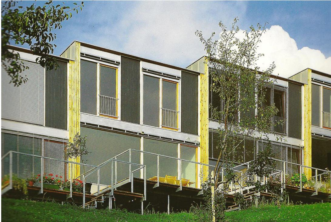
FIG 67: Colectores solares planos integrados na fachada de um conjunto habitacional em Batschuns, Vorarlberg, Áustria, de Walter Unterainer, 1997.
