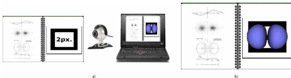
Fig. 3. a) Uma vez reconhecido o padrão, o modelo da orbital (estático ou dinâmico) irá aparecer sobreposto ao respectivo marcador e a sua representação poderá ser feita, por exemplo, de forma não imersiva no monitor do computador; b) Ao manipular a placa (que pode estar incorporada num manual), o objecto virtual realizará os mesmos movimentos do marcador, como se a ele estivesse preso.
