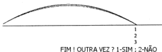
Fig. 2 - Trajetórias e alcances respectivos para três lançamentos a 2 m de altura, tendo em conta a resistência do ar. Notar que o ângulo óptimo (para maior alcance) é 44,5° e não 45°, como aconteceria sem altura inicial e sem resistência do ar.
