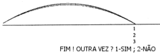
Fig. 3 - Trajectórias e alcances respectivos para três lançamentos a 2 m de altura e sem resistência do ar. Notar que o ângulo óptimo (para maior alcance) é 44,5^\circ e não 45^\circ , como aconteceria sem altura inicial.
