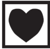
Figura 44 - Símbolo representativo de uma parte aplicada de tipo CF.
