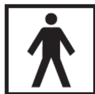
Figura 43 - Símbolo representativo de uma parte aplicada de tipo BF
