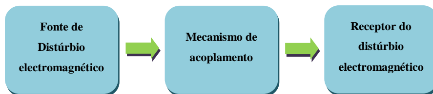
Figura 51 - Modelo do acoplamento elementar da interferência electromagnética.
