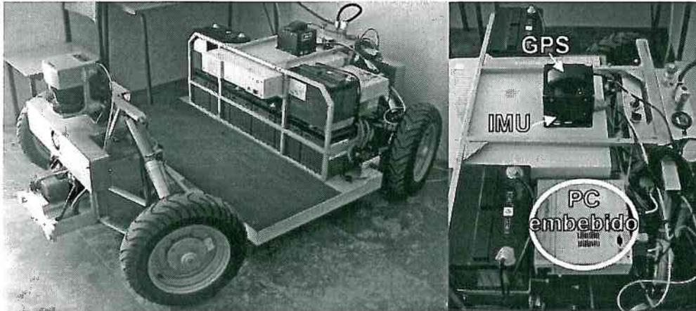
Figura 5.1: Protótipo do sistema de navegação incluído no CyberCar
