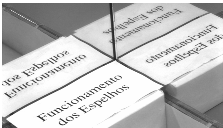
Figura 2.8: Simetria criada pelo espelho. Um espelho inverte a direcção normal à superfície do espelho da cena 3D. Dependendo do posicionamento do espelho, a inversão pode ser feita da direita para a esquerda (parte esquerda da figura) ou do topo para o fundo (parte direita da figura). Quando ambas as inversões são feitas ao mesmo tempo obtém-se o mostrado na parte central da figura.
