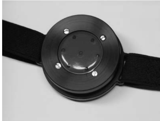
Figura 2.15: Sensor de fotopletismografia para aquisição do sinal de onda de pulso periférica [10].
