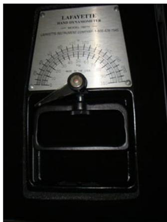
**Figura 15:** dinamômetro da marca Lafayette®, modelo 78010, imagem Mônica Rezende, 2008.
