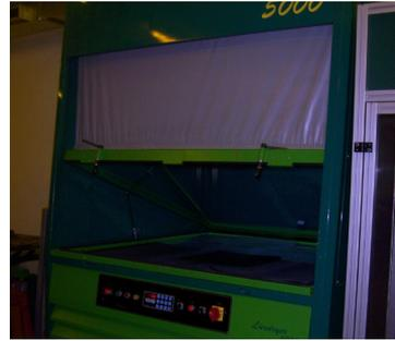
Imagem 53. Máquina de insolação dos quadros serigráficos (VOX)
