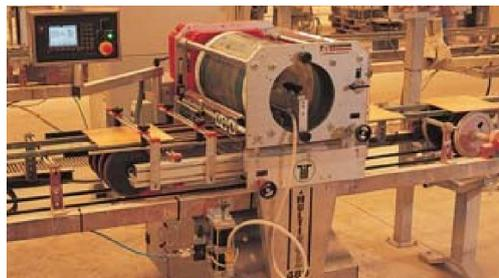
Imagem 62. Mecanismo de funcionamento da rotogravura
