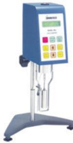
**Figura 3.7** - Viscosímetro Brookfield modelo DV-II + PRO.
