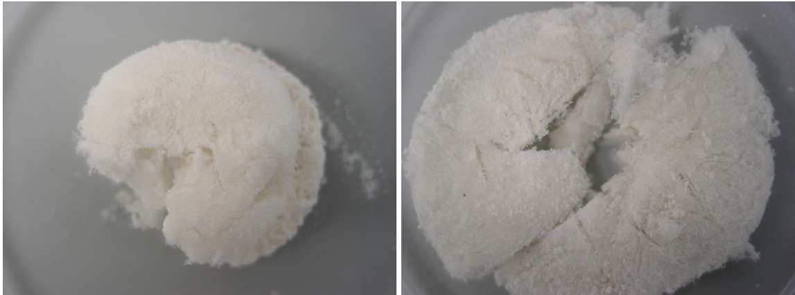
Figura 6.1: Microesferas liofilizadas com congelamento a -40^{\circ}\text{C} em banho de etanol a 96% (à esquerda) e com congelamento a -20^{\circ}\text{C} em frigorífico (à direita).
