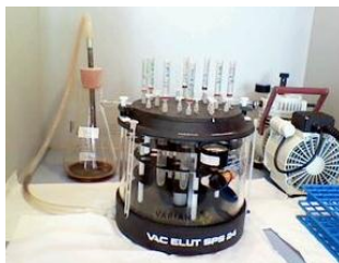
Figura 18 - Sistema de Extração VacElut SPE 24 (Varian), com colunas Oasis HLB 3cc (Waters), e bomba de Vácuo.
