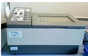
Figura 19 - Evaporador de amostras TurboVap. As amostras são evaporadas por submersão num banho a 40°C e ao mesmo tempo são pulverizadas com azoto.
