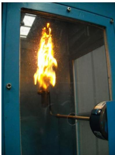
Figura 78 – Exemplo de ensaio em com ventilação descendente e  $\theta=-90^\circ$
