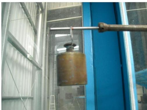
Figura 23 – Objecto de massa conhecida suspenso no TO para calibração
