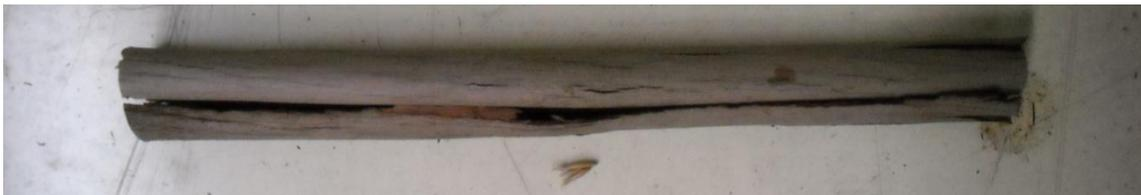
Figura 10 – Rasgo longitudinal nas cascas de eucalipto ensaiadas
