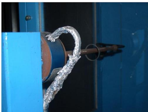
Figura 21 – Imagens da célula de carga do TO.
