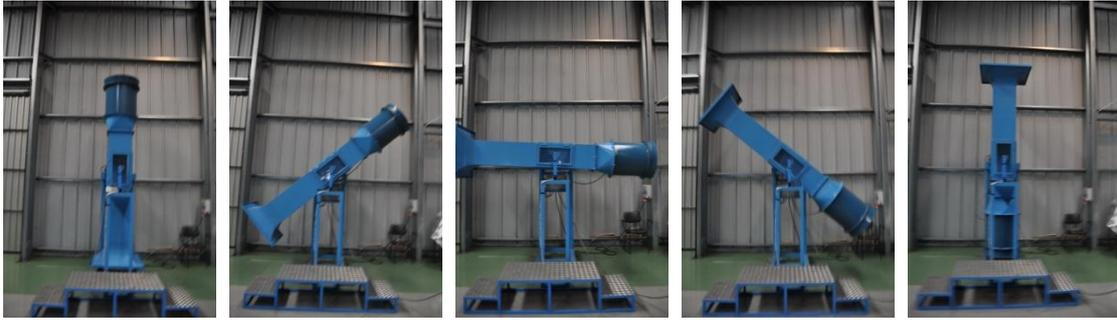
Figura 12– Imagens do túnel oblíquo com diversas direcções de incidência do escoamento.
