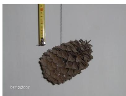
Figura 4 – Exemplo de ensaio para determinação do centro massa
