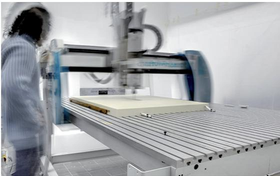
Máquina de Corte de três eixos
