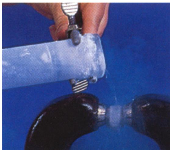
Fig. 2.7. O oxigénio é paramagnético, sendo por isso atraído pelos pólos de um íman. O oxigénio líquido derramado, é mantido entre dois pólos magnéticos [Fishbane1996] pp.875.
