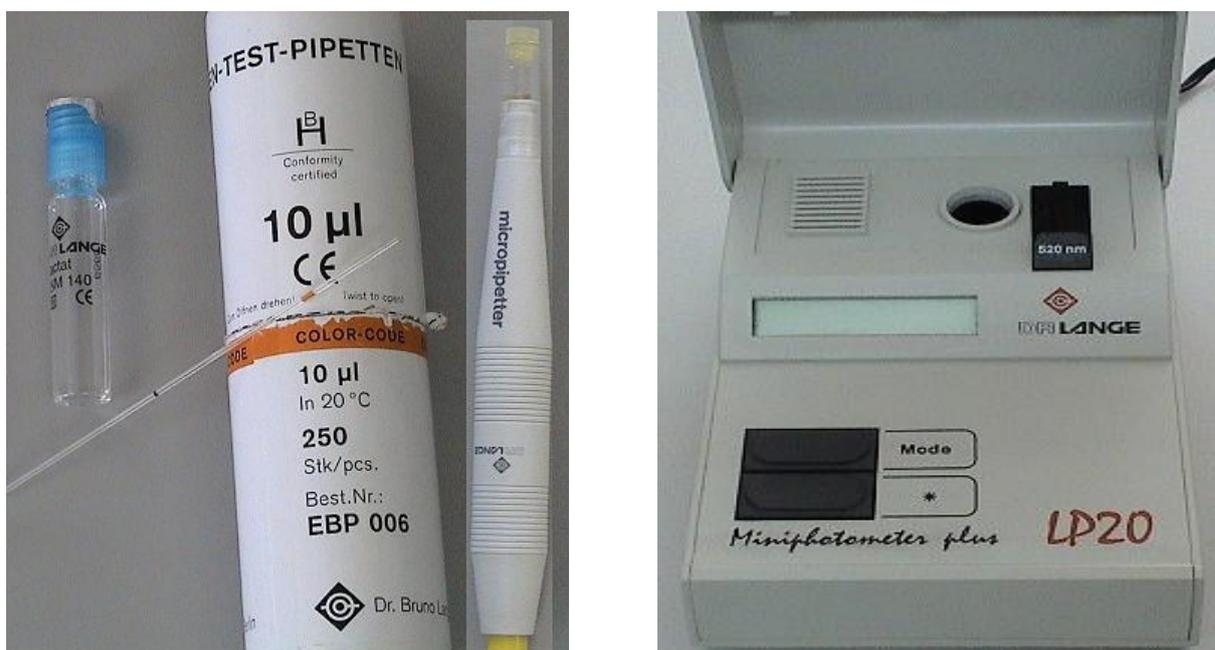
**Figura 15.** Capilar e respectiva caixa; micropipeta marca DR. LANGE, solução tampão “Lactatc Enzimat” marca DR. LANGE; mini-espectrofotómetro, de marca DR. LANGE
