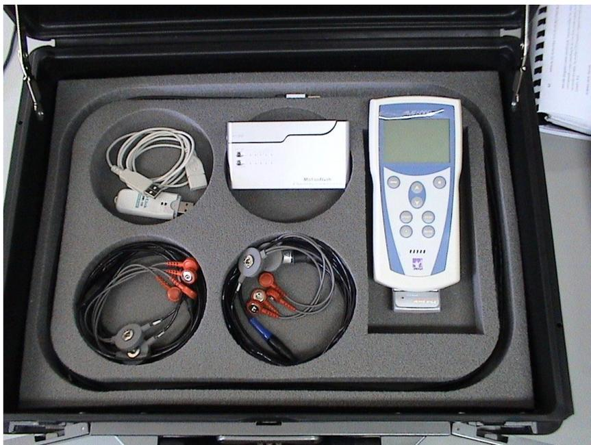
**Figura 113.** Sistema de registo electromiográfico MEGAWIN<sup>®</sup> da MEGAELECTRONICS<sup>®</sup>, com uma CMRR de 110 dB.
