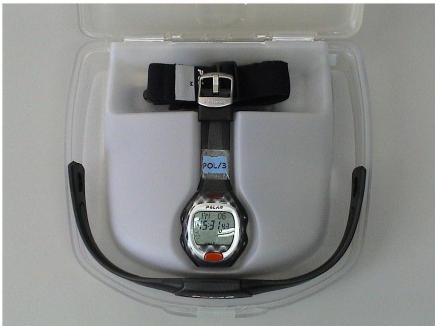
**Figura 135.** Sistema utilizado para a medição da frequência cardíaca. Banda transmissora, marca POLAR®, modelo T81-CODED; cinto elástico, da marca polar, que permite ajustar a banda ao tórax do atleta; Cardiofrequencímetro, marca POLAR®, modelo 810, série S.
