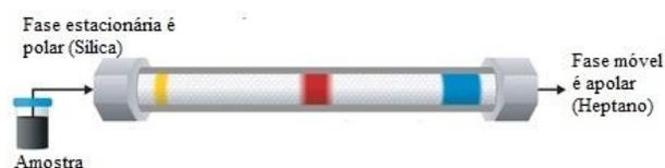
**Figura 3.1-** Esquema de Coluna e respectiva fase móvel em cromatografia de fase normal
