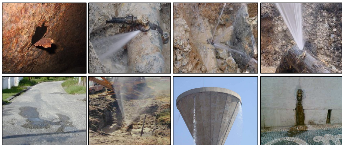
Figura 2.8 – Perdas de água em diversas zonas de um sistema de distribuição de água.
