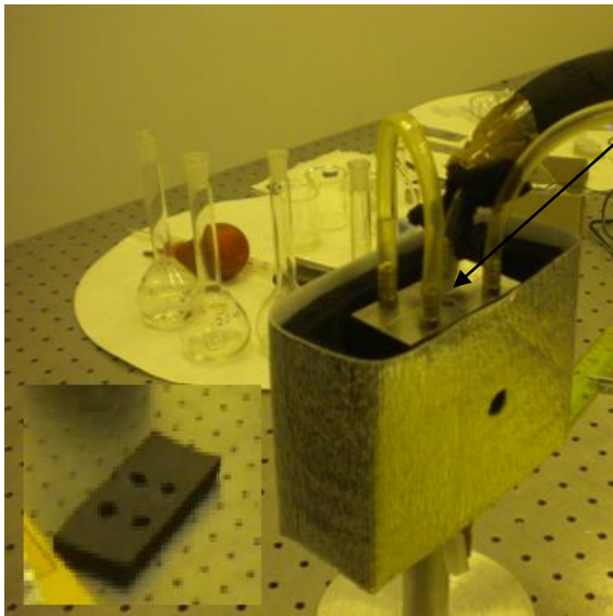
Fig.27 - Termómetro colocado no bloco 1 na saída da amostra.
