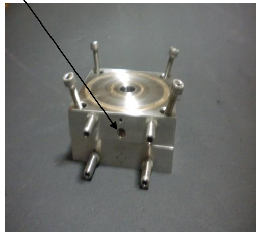
Fig.27 - Termómetro colocado no bloco 1 na saída da amostra.
