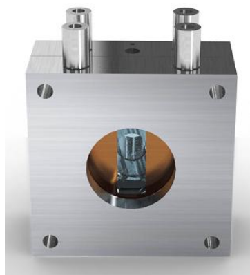
Fig.11 - Separador de cobre pressionado entre os dois blocos. A imagem é um desenho construído através do software 3D-MAX.
