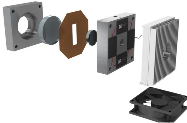
Fig.33 – Componentes da célula Peltier.
