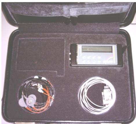
**Figura 18.** Sistema de registo electromiográfico MEGAWIN<sup>®</sup> da MEGAELECTRONICS<sup>®</sup>, com uma RRMC = 120 dB
