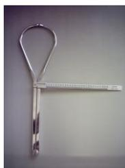
**Figura 13.** Compasso de pontas redondas GPM<sup>®</sup>.
