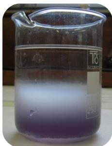
**Figura 4.1:** Fotografia duma mistura  $\text{Cr}^{3+}/\text{SDS}$ , para uma razão molar igual a 4, após mais de 6 horas em repouso. A separação de fases que ocorre é visível.
