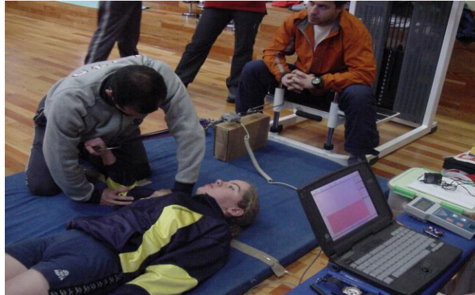
Fig. 14 – Avaliação da força isométrica máxima com o sensor de força e amplificador digital (FPN - 2004)
