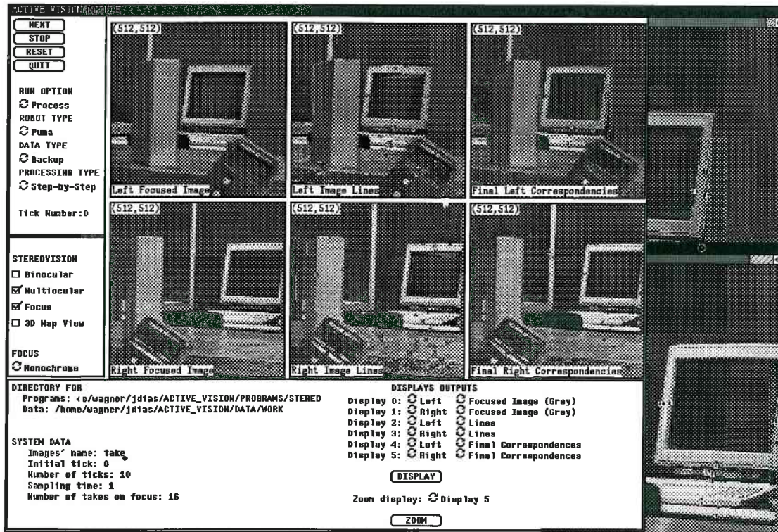
Figura 6.54 - Os programas permite a utilização de imagens de dimensão variável podendo ser utilizada a opção de zoom. A figura ilustra a execução do programa na opção de focagem e com imagens (512x512).
