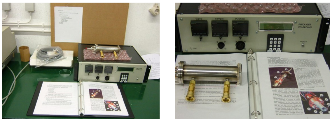
Figura 1. Sistema pirólise pulsada construído na Universidade de Boulder (Colorado), 42 adquirido para instalação no LMCB do Departamento da Química da Universidade de Coimbra.
