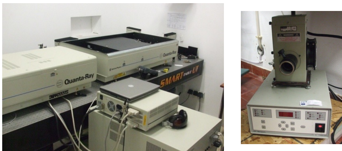
Figura 2. Equipamento utilizado nas experiências de irradiação das matrizes criogénicas: Laser com oscilador paramétrico óptico e lâmpada de Hg(Xe).
