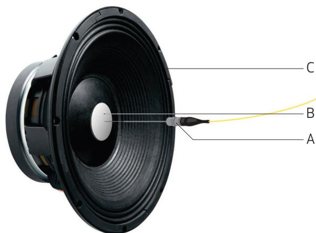
FIGURA 7.13: Montagem para aquisição de sinal *self-mixing* no altifalante, onde se podem ver: *A* a micro-sonda, *B* o espelho reflector, e *C* o altifalante.
