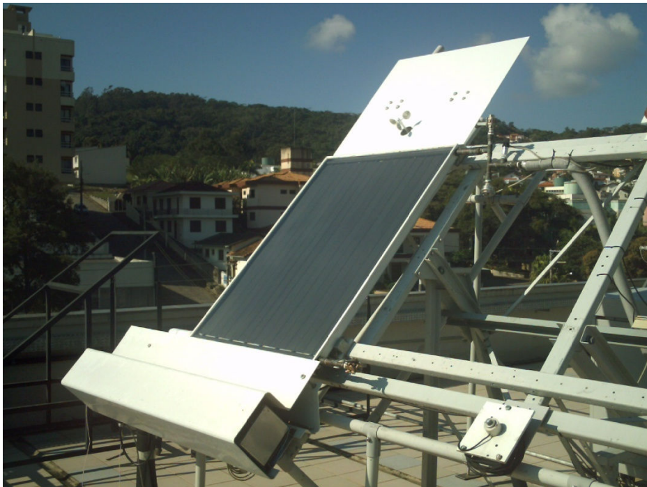
Figura 18 - Colector CSP - 140V testado na Bancada do LabSolar.
