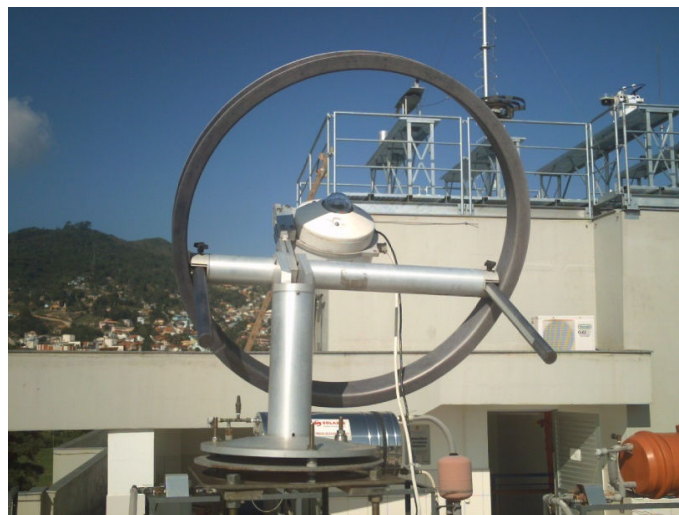
Piranómetro com anel sombreador para a medição da radiação difusa
