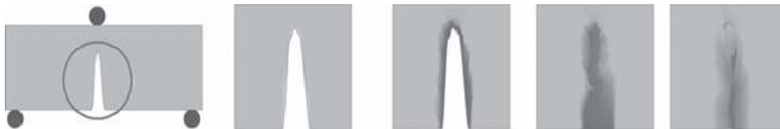
Figura 1.1- Princípio de auto-reparação de materiais [2]
