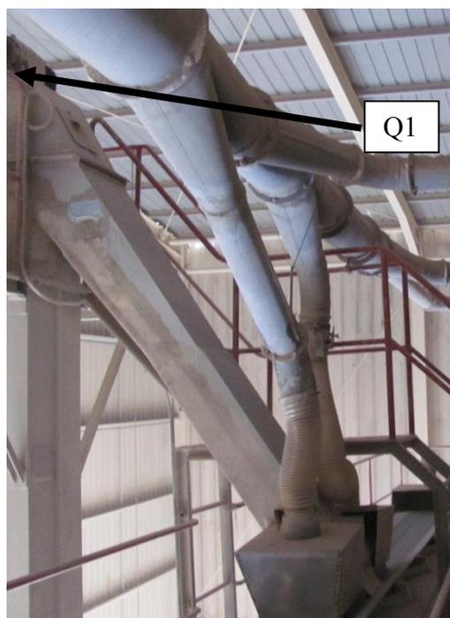
**Figura 16 – Pontos de aspiração na transição de um elevador para uma passadeira**
