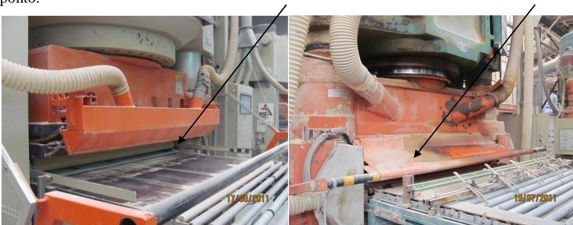
**Figura 30 – Prensa sem e com aplicativo de melhoramento**
