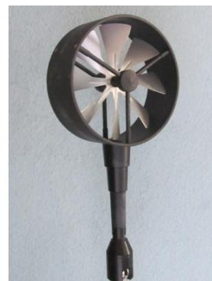
Figura 24 – Anemómetro de hélices
